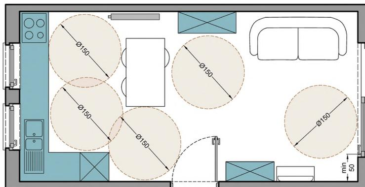
*Min. 6 % de la superficie utile du logement doit être consacré à des rangements accessibles*
