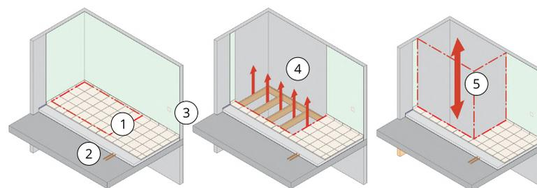
1. Joint prévu à hauteur du plancher démontable
