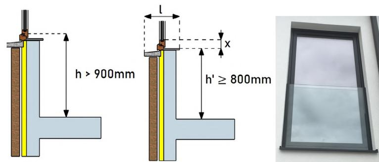
Figure 3: Gauche : la hauteur de protection est 900 mm ou plus
