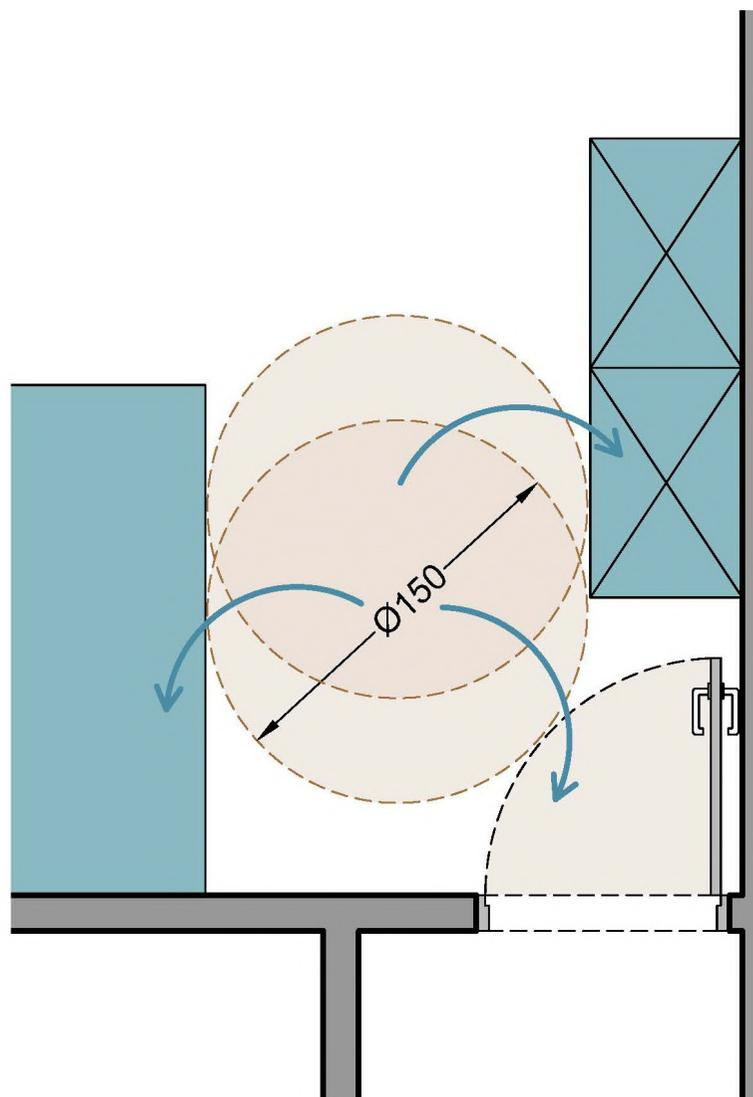
*Exemple d'une chambre adaptable : superposition des aires de rotation desservant l'armoire, la porte et un côté du lit.*
